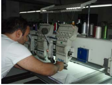
Fotoğraf 13. Üst İplik Düzeneği (Emine Koçak arşivi)
