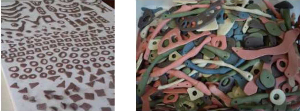
Görsel 6. Akıtma yolu ile elde edilmiş seramikler (Fırınlama öncesi ve sonrası) (N. Yeşilmen)
