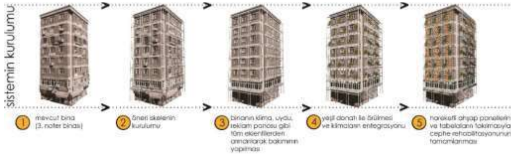
Şekil 5: Cephe Rehabilitasyonu Bağlamında Tasarlanan Süreç Ve Sistem Kurulumu
