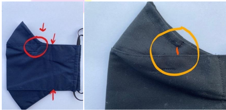
Görsel 6: Dikişinde kayma olan ve burun paneli tutturma dikişinin yerinin doğru yapılmadığı 3D kumaş maske örnekleri.
